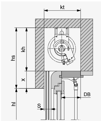
Bei Handantrieb steht die Endschiene unter dem Sturz 20 mm ins Licht.
