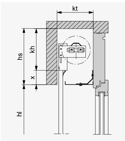
Mit Untersichtsblende. Bei Handantrieb steht die Endschiene unter dem Sturz 20 mm ins Licht.
