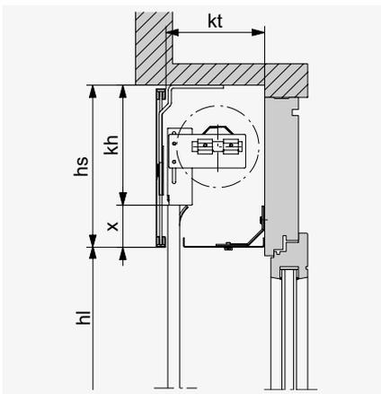
Bei Handantrieb steht die Endschiene unter dem Sturz 20 mm ins Licht.
